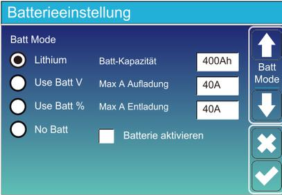
**Batteriekapazität:** Hierdurch erfährt der Deye Hybrid-Wechselrichter die Größe Ihrer Batteriebank.
