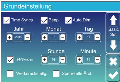
**Werksrückstellung:** Alle Parameter des Wechselrichters zurücksetzen.
