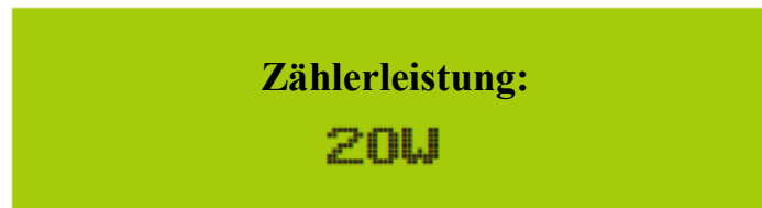
Abb. 7.16 Einschalten der Null-Export-Funktion über Energiezähler
